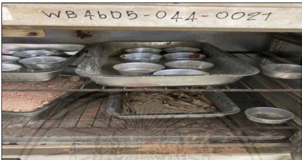
รูปที่ 20 ตัวอย่างการนำตัวอย่างเข้าเตาอบ
