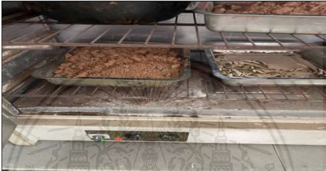
รูปที่ 10 นำตัวอย่างดินเข้าเตาอบ
