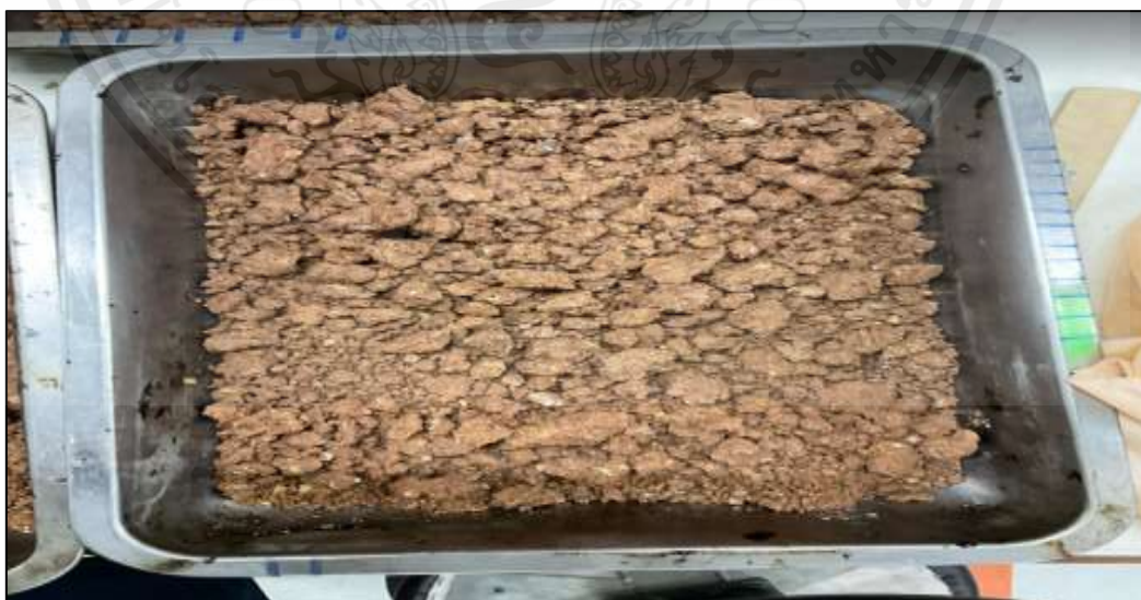
รูปที่ 38 ทำการแยกดินด้านบนโมลและดินด้านล่างโมลเพื่อทำการทดสอบ Sieve Analysis
