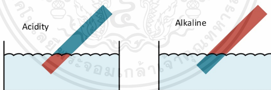
รูปที่ 2.1 การวัดความเป็นกรด - ด่าง ด้วยกระดาษลิตมัส
