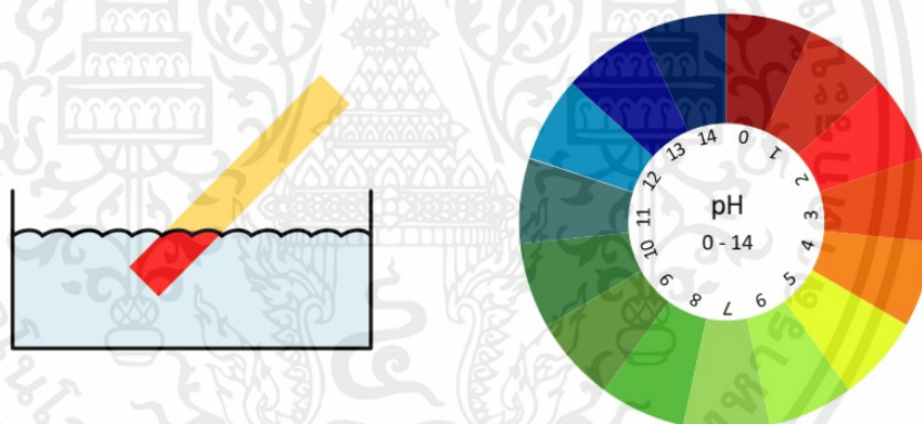
รูปที่ 2.2 การวัดค่าความเป็นกรด - ด่างด้วยยูนิเวอร์ซัลอินดิเคเตอร์
