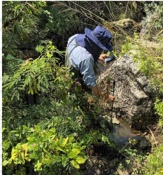
รูปที่ 3.5 การวัดอัตราการไหลของน้ำโดยใช้เครื่องมือวัดกระแสน้ำแบบดิจิตอล (JDC Flowatch Flowmeter)
