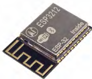
รูปที่ 2.6 โมดูล ESP3212 ที่ Ai-Thinker ร่วมกับ Seeedstudio
