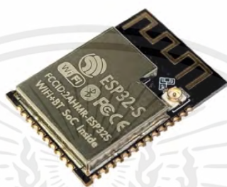
รูปที่ 2.7 โมดูล ESP32S ที่ Seeedstudio
