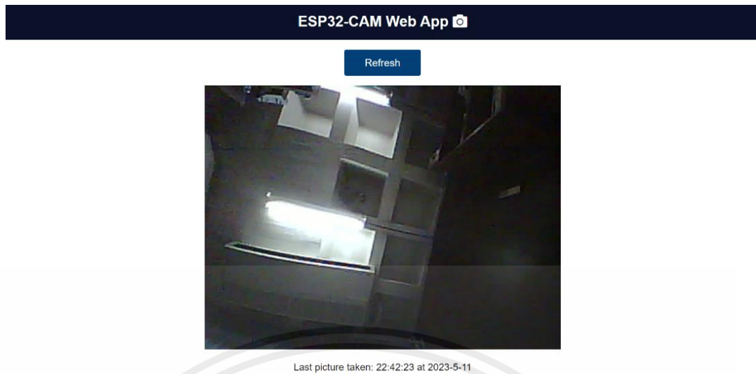
รูปที่ 4.8 ตัวอย่างการแสดงรูปภาพที่บันทึกขณะที่มีการเปิดปิดตู้บนเว็บไซต์
