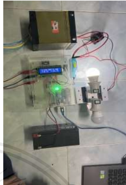
รูปที่ 4.6 ต่ วงจร Inverter เข้ากับหลอดไฟ 1 หลอด
