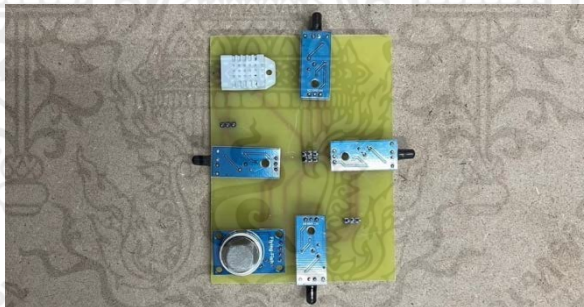
รูปที่ 4.1 MQ2, DHT22 และ Flame Sensor ที่เชื่อมลงบนบอร์ดเดียวกัน
