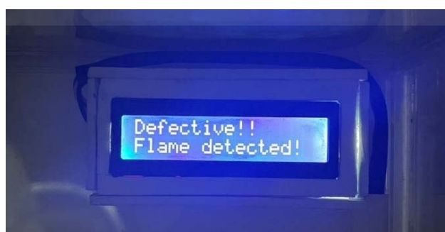
รูปที่ 4.11 หน้าจอ LCD เมื่อตรวจพบเปลวไฟก่อนปัจจัยอื่น
