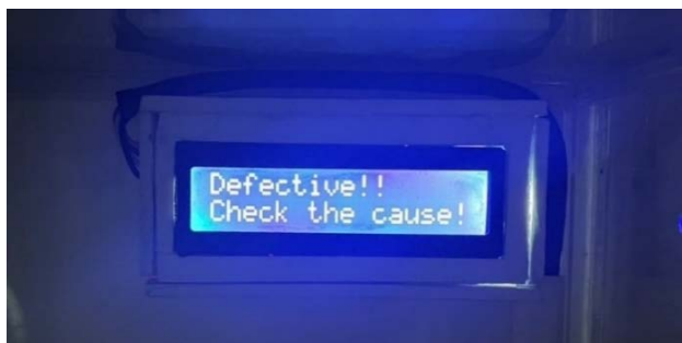
รูปที่ 4.12 หน้าจอ LCD เมื่อพบเปลวไฟ คว้นและอุณหภูมิ ที่ค่าเริ่มมากผิดปกติให้เฝ้าระวัง
