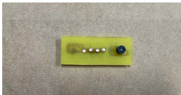
รูปที่ 4.2 LED และ Buzzer ที่เชื่อมลงบนบอร์ดเดียวกัน
