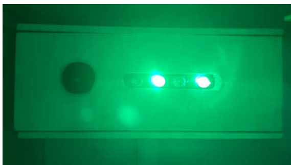
รูปที่ 4.8 LED แสดงผลลัพธ์เป็นไฟสีเขียวเมื่อตรวจไม่พบค่าของควีน, อุณหภูมิและเปลวไฟ
