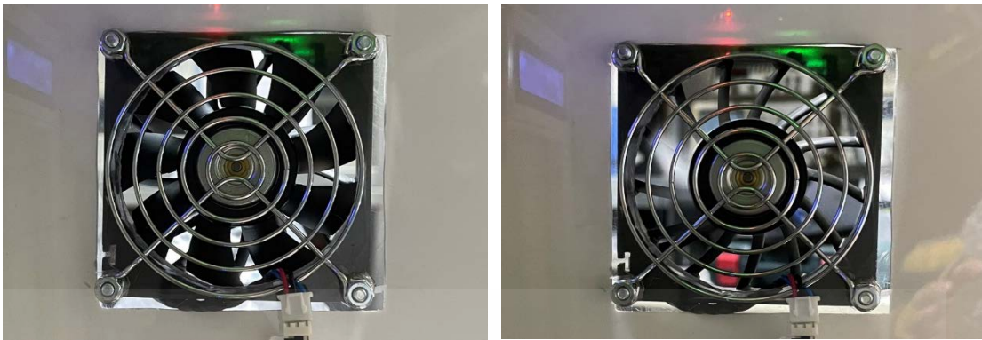
รูปที่ 4.14 การทำงานของพัดลมระบายอากาศที่ปิดในสถานการณ์ปกติและเปิดเมื่อเกิดอัคคีภัย
