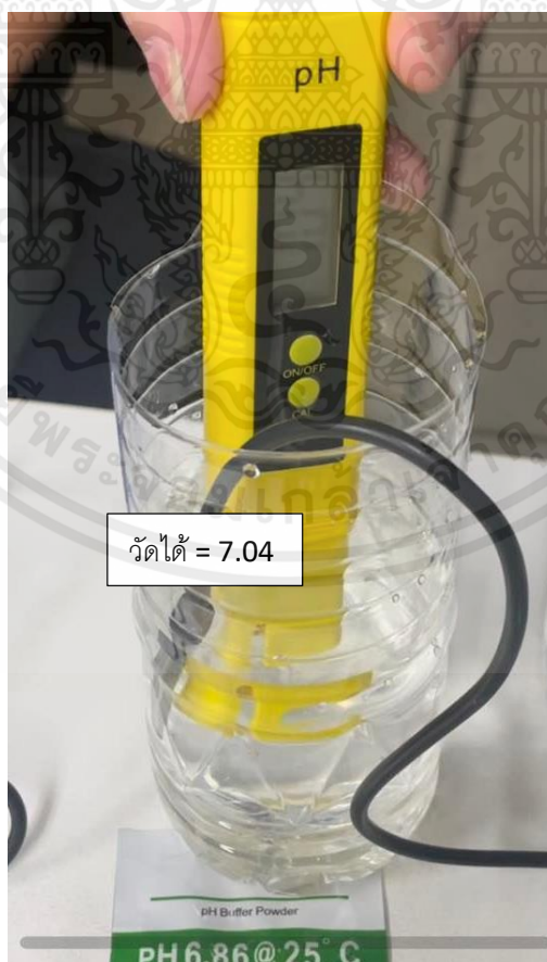
รูปที่ 4.7 ภาพขณะวัด pH = 6.86 ด้วยเครื่องมือวัด pH
