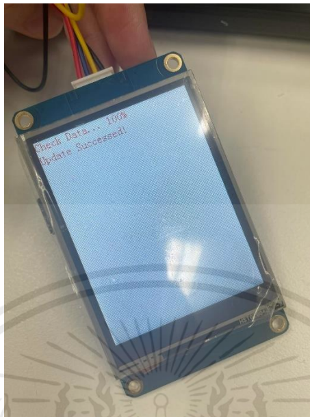
รูปที่ 3.43 รูปภาพแสดงการอัปเดตไฟล์ของจอ Nextion
