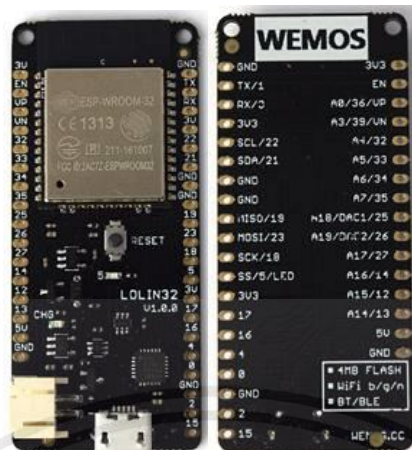
รูปที่ 2.21 บอร์ด WEMOS LOLIN32 ด้านหน้าและด้านหลัง
