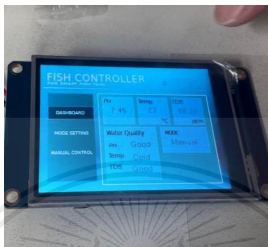
รูปที่ 4.4 ภาพขณะวัดอุณหภูมิของน้ำอุณหภูมิปกติด้วยเซนเซอร์
