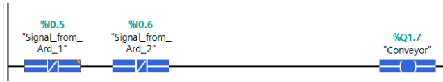
ภาพที่ 4.8 การออกแบบ Ladder Diagram เพื่อรับค่าสัญญาณจากอาร์ดูโน ไปยังพีแอลซี
