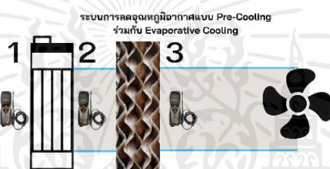
รูปที่ 3.20 การวัดความเร็วลมของระบบการลดอุณหภูมิอากาศแบบ Pre-Cooling ร่วมกับ Evaporative Cooling
