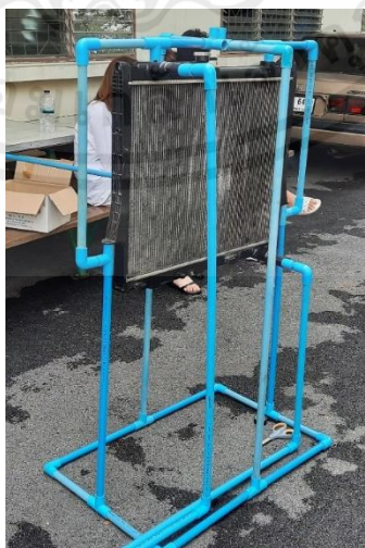
รูปที่ 2.10 หม้อน้ำอลูมิเนียมฝาพลาสติก
