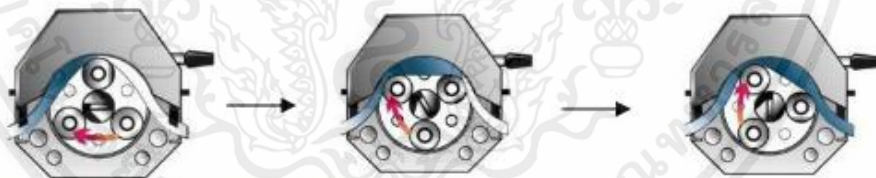
รูปที่ 2.8 ลักษณะการทำงานของปัมป์ดูดสารละลาย [8]
