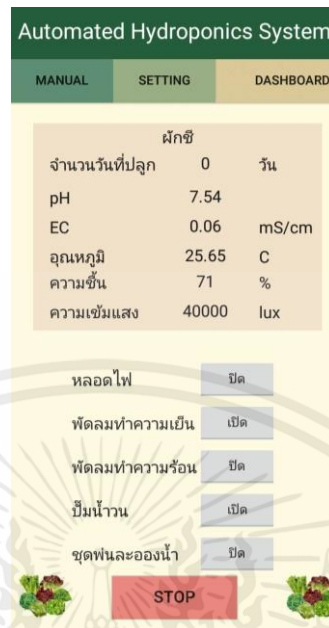
รูปที่ 4.40 เซนเซอร์ทำการส่งค่าที่วัดได้ไปที่แอปพลิเคชันในหน้า Dashboard
