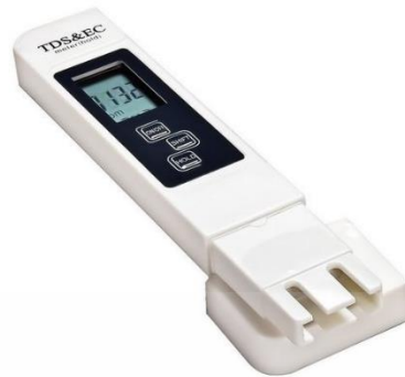
รูปที่ 4.17 ที่วัดค่า TDS และ EC รุ่น A8023
