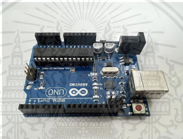
รูปที่ 3.14 ไมโครคอนโทรลเลอร์ Arduino Uno R3 (ATmega328P)
