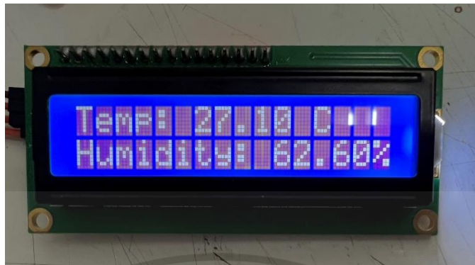
รูปที่ 4.27 หน้าจอแสดงผล Liquid Crystal Display (LCD) จะแสดงค่าอุณหภูมิและความชื้น
