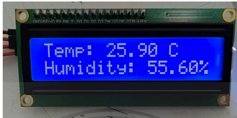
รูปที่ 4.36 หน้าจอแสดงผล Liquid Crystal Display (LCD) จะแสดงค่าอุณหภูมิและความชื้น
