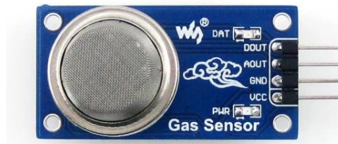
รูปที่ 2.4 เซนเซอร์ตรวจจับควัน Gas Sensor (MQ-2) [8]
