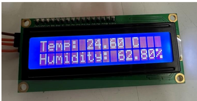
รูปที่ 4.51 หน้าจอแสดงผล Liquid Crystal Display (LCD) จะแสดงค่าอุณหภูมิและความชื้น
