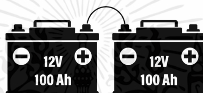
รูปที่ 2.13 การเชื่อมต่อแบตเตอรี่แบบอนุกรม [29]
