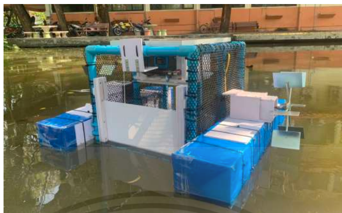
รูปที่ 4.13 ทดสอบความเร็วของมอเตอร์ที่ใช้สำหรับการเติมอากาศเพื่อบำบัดน้ำเสีย
