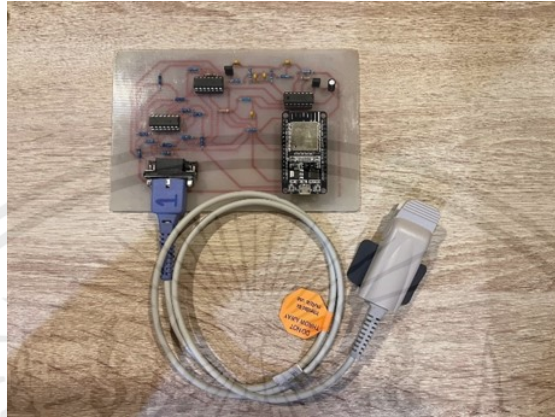
รูปที่ 4.5 วงจรรวมแบบไม่มี GND Plane ของอุปกรณ์วัดระดับน้ำตาลในเลือดโดยใช้แสง
