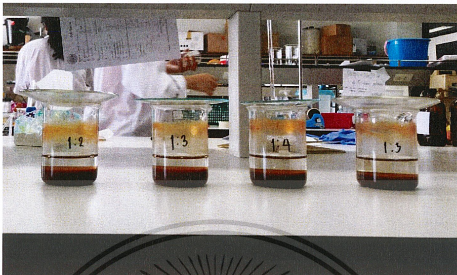
รูปที่ จ-7 ทำการตกตะกอนเหล็กไอออนด้วยโซเดียมไฮดรอกไซด์(NaOH) จากนั้นทิ้งให้เหล็กไอออนตะกอนเป็นเวลา 60 นาที
