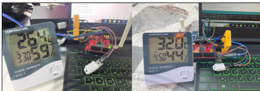
รูปที่ 4.3 การทดสอบวัดค่าอุณหภูมิและความชื้นจากเซนเซอร์ DHT22
