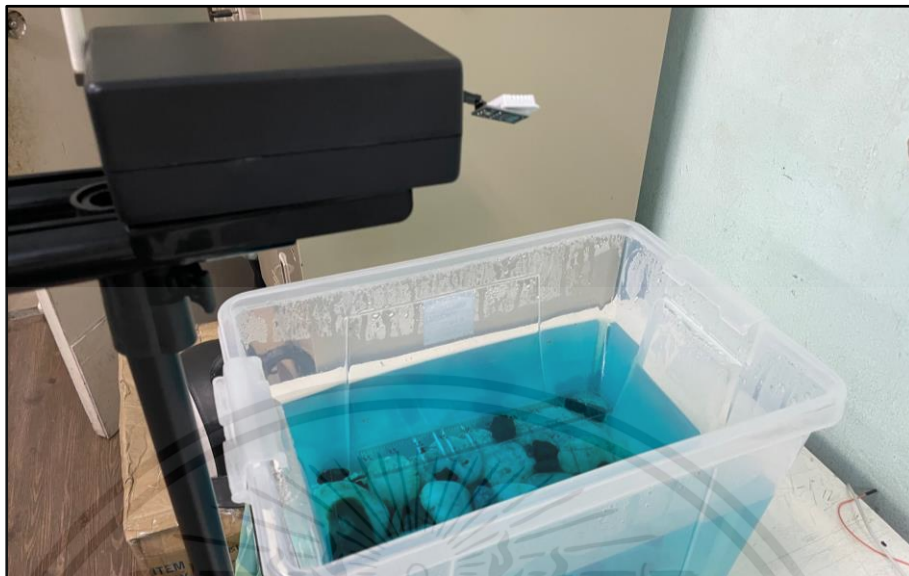
รูปที่ 3.4 ชุดจำลองการเกิดภัยอุทกภัยติดตั้งร่วมกับกล่องสำหรับจัดเก็บอุปกรณ์ในภาคส่ง
