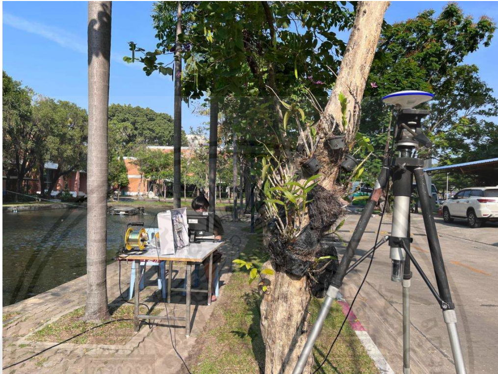
รูปที่ 4.12 การทดสอบระยะการรับสัญญาณรบกวนของเสาอากาศ AN-105L-GNSS (2)
