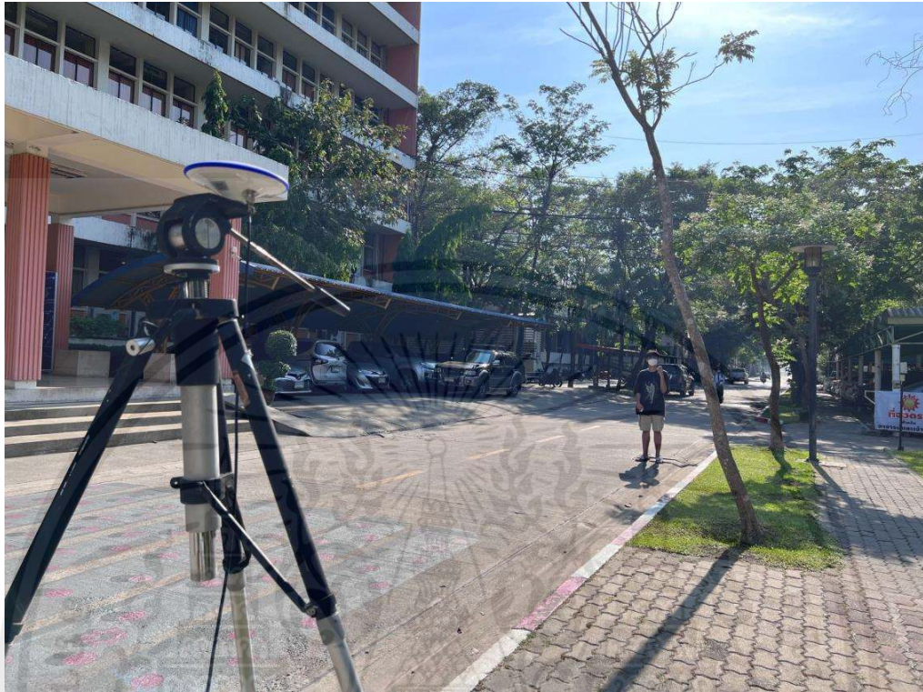
รูปที่ 4.11 การทดสอบระยะการรับสัญญาณรบกวนของเสาอากาศ AN-105L-GNSS (1)
