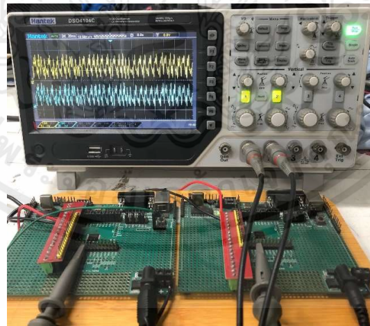
รูปที่ 4.15 การวัดรูปแบบสัญญาณ (waveform) ของ Jerk system บน FPAA ทั้งภาคส่ง และภาครับ
