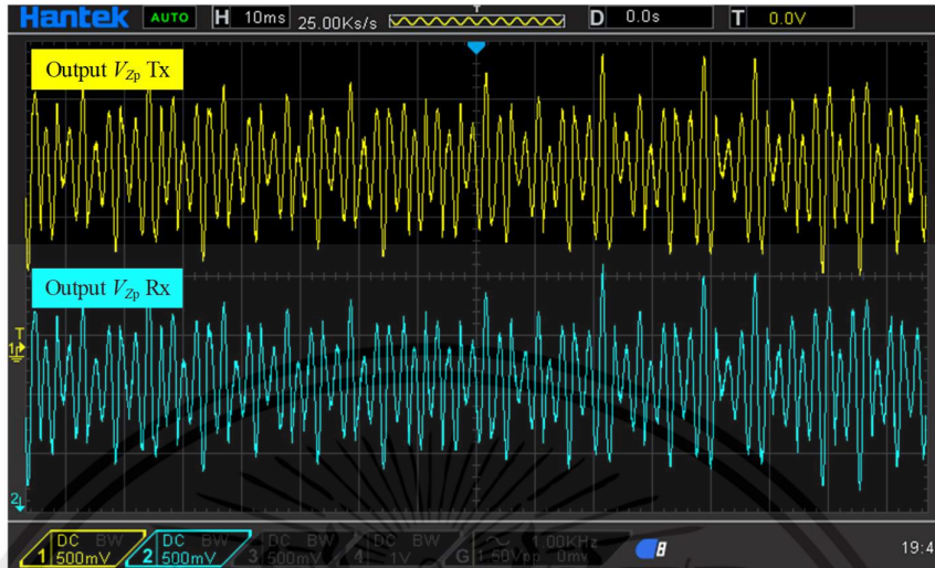
รูปที่ 4.18 รูปแบบสัญญาณ (waveform) ภาคลส่ง และภาครับของ Jerk system V_{zp} ของตัวแปรระบบ z
