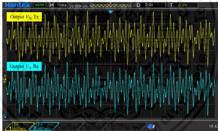
รูปที่ 4.17 รูปแบบสัญญาณ (waveform) ภาคส่ง และภาครับของ Jerk system V_{yp} ของตัวแปรระบบ y
