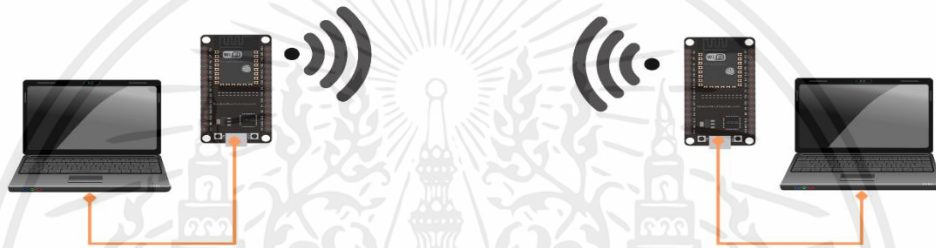
รูปที่ 3.7 ออกแบบการทดลองทดลองการรับ-ส่งข้อมูลด้วยระบบ ESP-NOW
