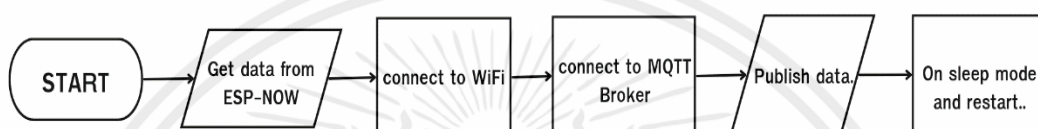
รูปที่ 3.10 การส่งข้อมูลด้วย MQTT บน ESP32
