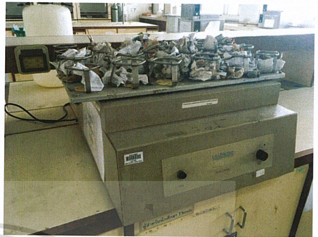
รูปที่ จ-4 เครื่องเขย่า (Shaker) รุ่น Orbital Shaker ยี่ห้อ Gallenkamp ใช้ในการเขย่า มีการควบคุมความเร็วรอบและเวลาเพื่อให้ขานอ้อยกับสีย้อมทำปฏิกิริยากัน แล้วโมเลกุลของสีย้อมเกิดการแทรกเข้าไปในรูพรุนของเส้นใยขานอ้อย
