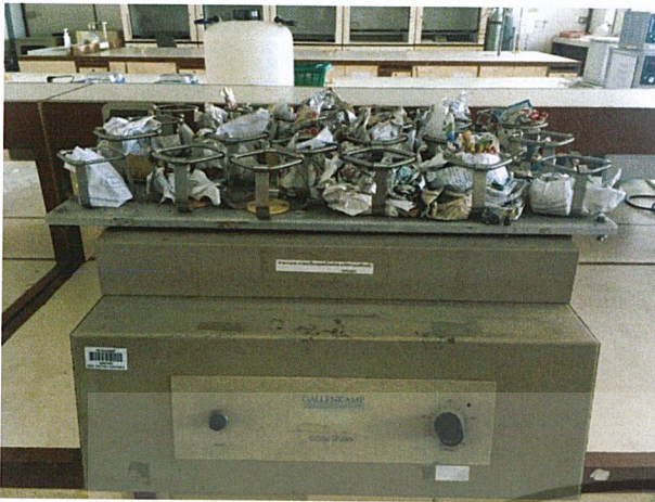
รูปที่ จ-4 เครื่องเขย่า (Shaker) รุ่น Orbital Shaker ยี่ห้อ Gallenkamp ใช้ในการเขย่า มีการควบคุมความเร็วรอบและเวลาเพื่อให้ขานอ้อยกับสีย้อมทำปฏิกิริยากัน แล้วโมเลกุลของสีย้อมเกิดการแทรกเข้าไปในรูพรุนของเส้นใยขานอ้อย
