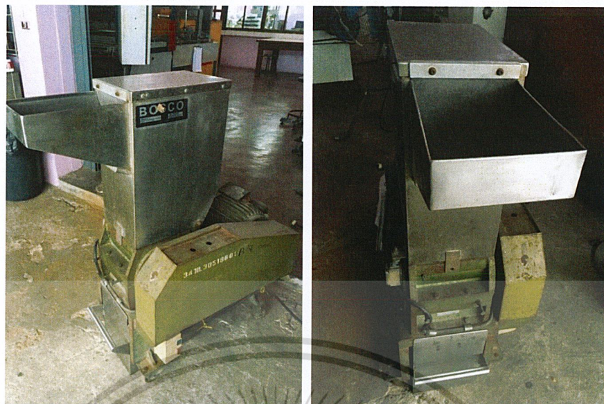
รูปที่ 4.2 เครื่องบด สำหรับบดขานอ้อยให้เป็นผง
