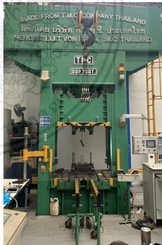
รูปที่ 4.21 การติดตั้งชุดแม่พิมพ์เข้ากับเครื่องปั๊มโลหะ
