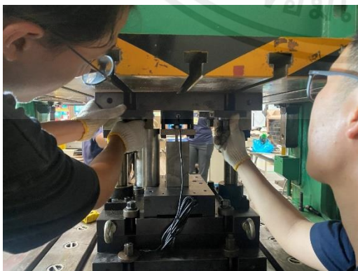
รูปที่ 4.21 การติดตั้งชุดแม่พิมพ์เข้ากับเครื่องปั๊มโลหะ
