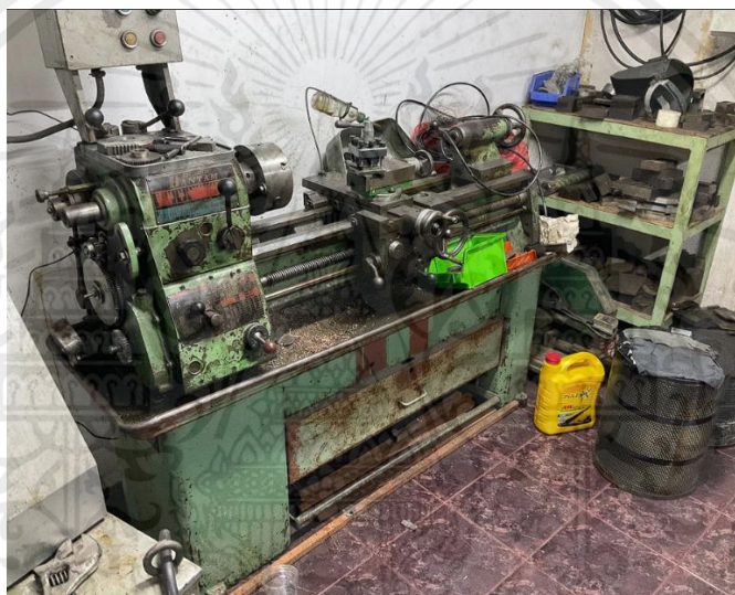
รูปที่ 3.11 เครื่องจักรที่ใช้ในการกลึงขึ้นรูปปลั๊กเจอร์
