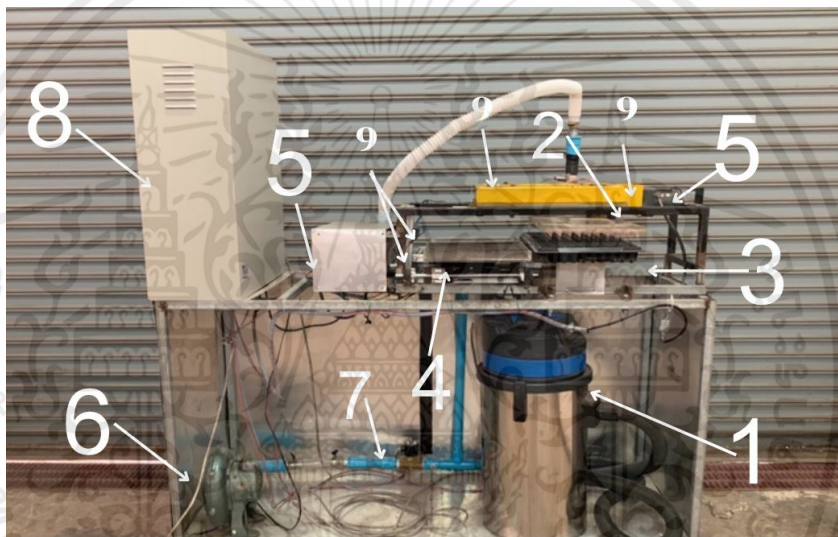
รูปที่ 3.3 เครื่องหยอดเมล็ดลงถาดเพาะกล้า
