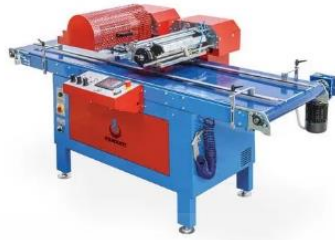
รูปที่ 2.21 เครื่องหยอดเมล็ดแบบ Drum tray seeder SEMLAMBDA65
