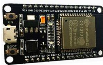
รูปที่ 3.2 ESP32 แหล่งที่มา https://www.artronshop.co.th/article/51/esp32
