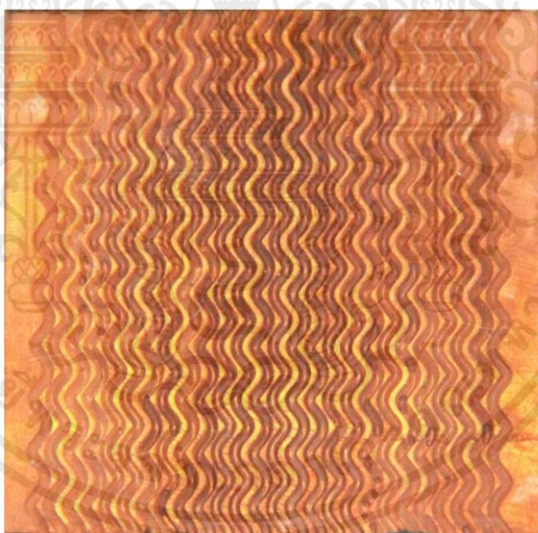
ภาพที่ 5.5 การไหลที่อัตราการไหลของน้ำ 300 CCM และอัตราไหลของอากาศ 1 LPM
