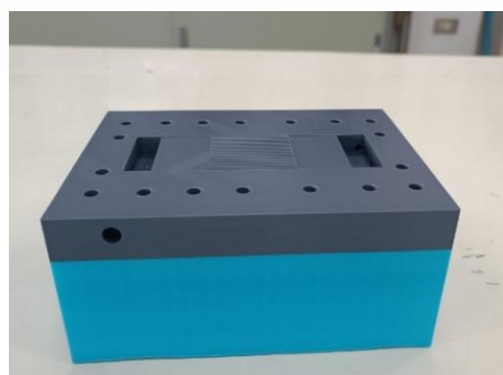
ภาพที่ 4.20 โมเดลต้นแบบจากเครื่องปริ้นต์ 3 มิติ
