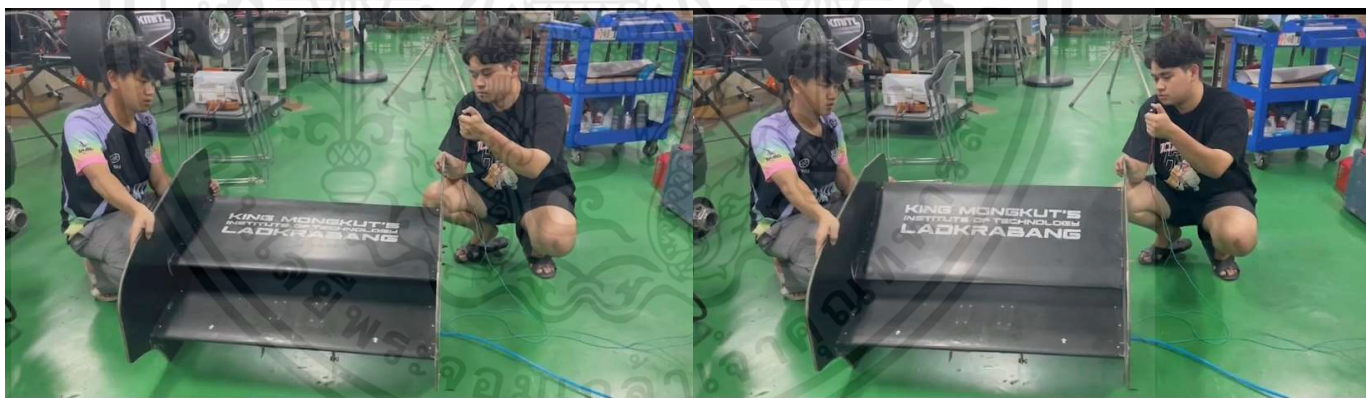
รูปที่ 3.30 แสดงการทำงานของ DRS ขณะเปิดและปิด
