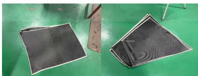
รูปที่ 3.23-3.24-3.25 ตัดผ้าคาร์บอนให้ได้ขนาดโดยเผื่อขนาดตอนหุ้มโมลไว้ด้วย
