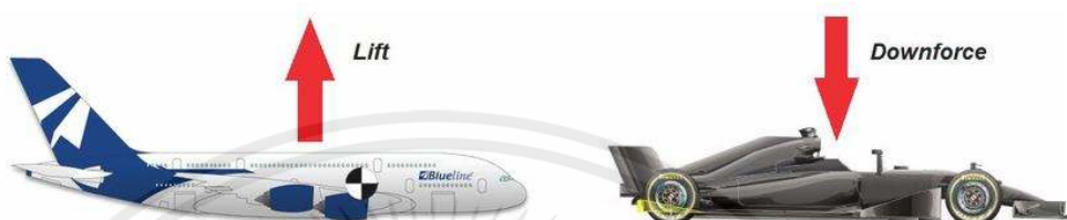
รูปที่ 2.2 รถแข่งใช้ปีกเครื่องบินกลับด้านเพื่อสร้างแรงกดแทนแรงยก
