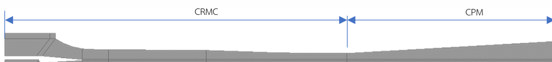
รูปที่ 4.13 Ejectorแบบผสมโดยครึ่งหน้าเป็นCRMCครึ่งหลังเป็นCPM
