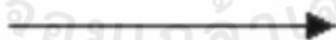
รูปที่ 2.4 แสดงสัญลักษณ์แทนกระแสข้อมูลเป็นลูกศร ( Data Flow )
