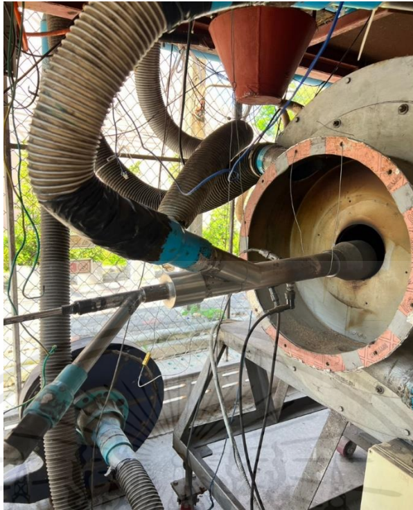
ชุดหัวเผาของเตาเผา มีจุดเชื่อมต่อระหว่าง Compress Air, LPG, Spark plug และ ลม Q1
