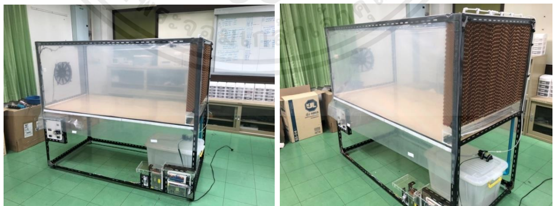
รูปที่ 3.29 ติดตั้งผ้าใบและแผงรังผึ้ง (Cooling Pad) สำหรับ EVAP
