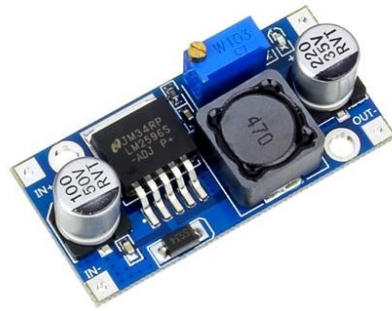
รูปที่ 3.8 DC to DC Converter
