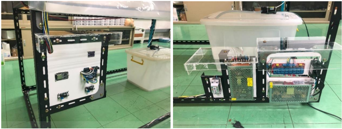
รูปที่ 3.27 ออกแบบและติดตั้งระบบไฟ
