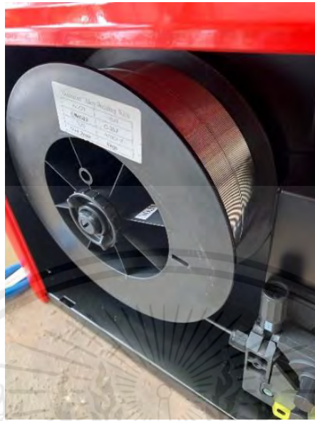
รูปที่ 3.4 ลวดเชื่อมอลูมิเนียม ER4043 ขนาดเส้นผ่านศูนย์กลาง 1.2 มิลลิเมตร
