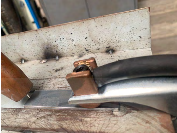
รูปที่ 3.8 บริเวณที่ทำการจับยึดด้วยสายดิน
