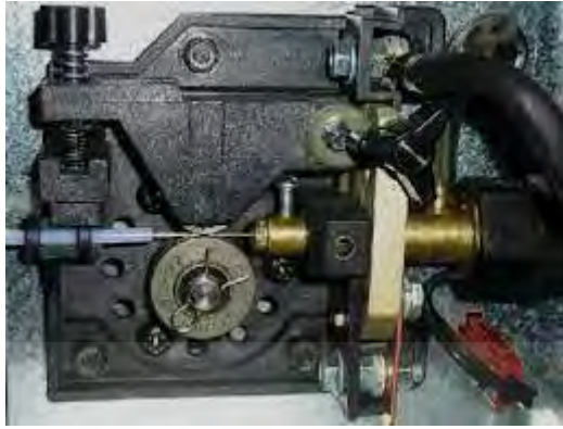
รูปที่ 2.6 ล้อป้อนลวดและล้อตัดลวดเชื่อมชนิด 2 ล้อ
