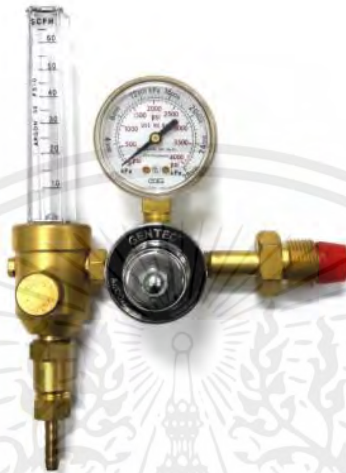
รูปที่ 2.16 ชุดควบคุมการไหลของแก๊สปกคลุมใช้สำหรับแก๊สผสม
