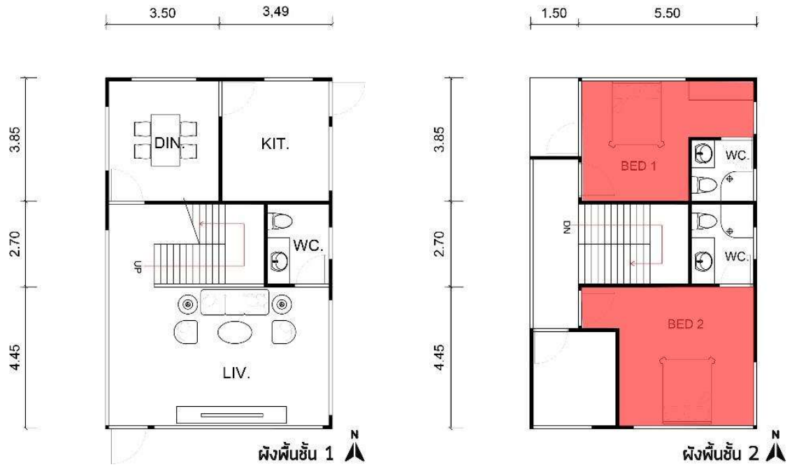
รูปที่ 3.2 แสดงผังบ้านพักอาศัยพื้นฐานและตำแหน่งพื้นที่ปรับอากาศ ที่มา : ผู้วิจัย
