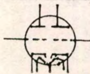
ภาพที่ 5.46 ลักษณะและสัญลักษณ์ของหลอดสุญญากาศชนิดต่าง ๆ
