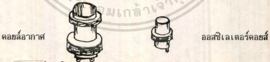
ภาพที่ 5.38 แสดงสัญลักษณ์และลักษณะของคอยล์แกนอากาศ
