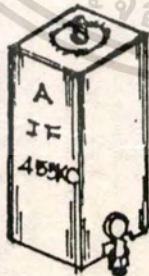
ก. ไอเอ็มคอยล์และออสซิลเลเตอร์คอยล์ในเครื่องรับวิทยุทรานซิสเตอร์
