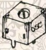
ก. ไอเอ็มคอยล์และออสซิลเลเตอร์คอยล์ในเครื่องรับวิทยุทรานซิสเตอร์
