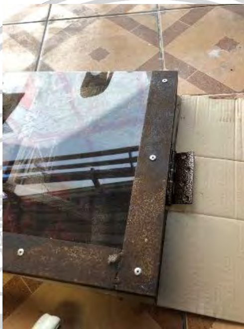
ภาพที่ 3.23 : การติดวัตถุโลหะและพลาสติกใสเข้าด้วยกัน
