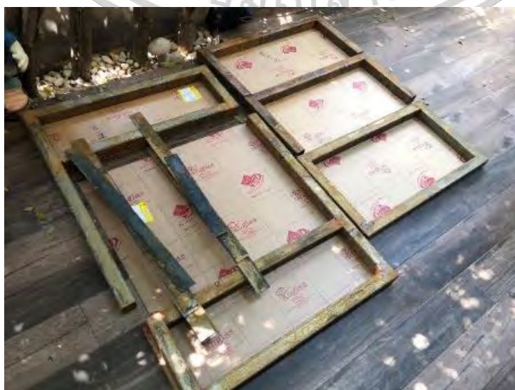
ภาพที่ 3.22 : เชื่อมโลหะขนาด 80 x 120 ซม. โดยใช้กรดเกลือทาประมาณ 2-3 วัน ให้เกิดสนิม
