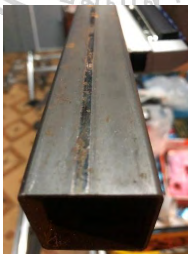
ภาพที่ 4.37 : การวิเคราะห์พื้นผิวของโลหะโดยวิธีธรรมชาติตากฝนตากแดด ผลงานชิ้นที่ 1
