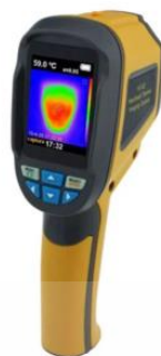
ภาพที่ 3.3 แสดงเครื่องมือกล้องถ่ายภาพความร้อน (THERMAL IMAGING CAMERA)
