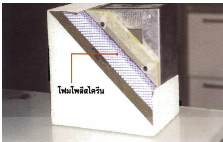
ภาพที่ 2.15 แสดงฉนวนกันความร้อนโพลีเอทรีนโฟม (Polyurethane foam)
