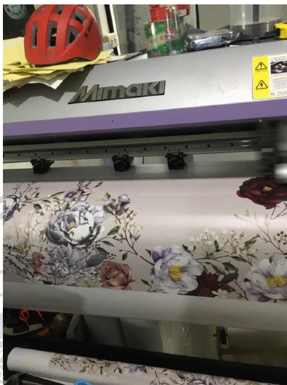
รูปที่ 3.15 เครื่องพิมพ์ภาพลงผ้าใบแคนवास
