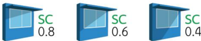
รูปที่ 2.8 แสดงตัวอย่างค่าสัมประสิทธิ์การบังแดด
