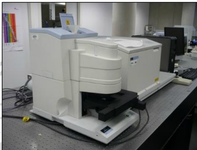
รูปที่ 3.22 เครื่อง FTIR รุ่น Perkin elmer spectrum GX
