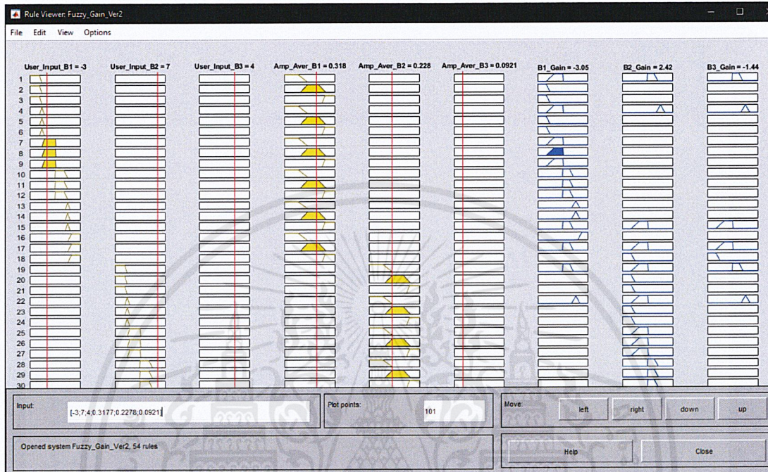
รูปที่ 4.10 รูปแสดงตัวอย่างการใช้ FIS Tools ในการหาค่า Gain ผลลัพธ์ค่า Gain ที่ได้จากการทดลองสัญญาณอินพุตต่างๆ แสดงอยู่ในตารางที่ 4.3
