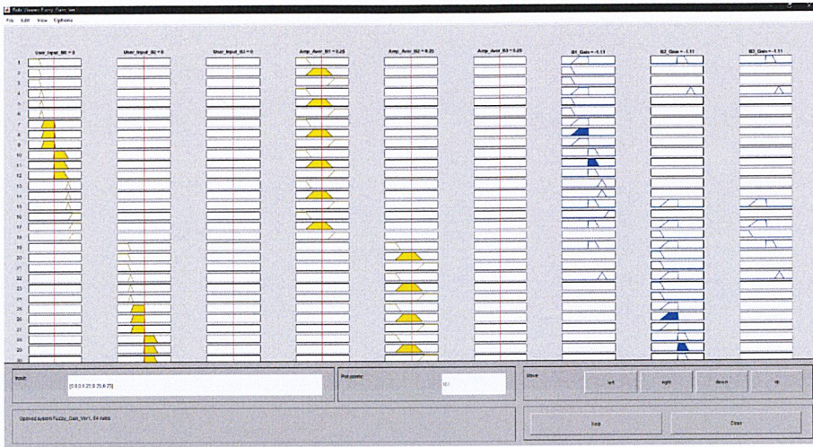
รูปที่ 3.10 รูปแสดงหน้าต่าง Rules ของส่วนการคำนวณ Gain บน FIS Tools
