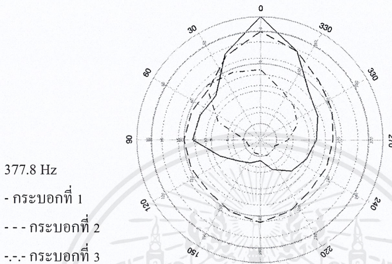
รูปที่ 4.1 การเปรียบเทียบการตอบสนองต่อความถี่ของกระบอกซอทั้ง 3 กระบอกที่ตอบสนองต่อความถี่ที่ 377.8 Hertz โน้ต G
