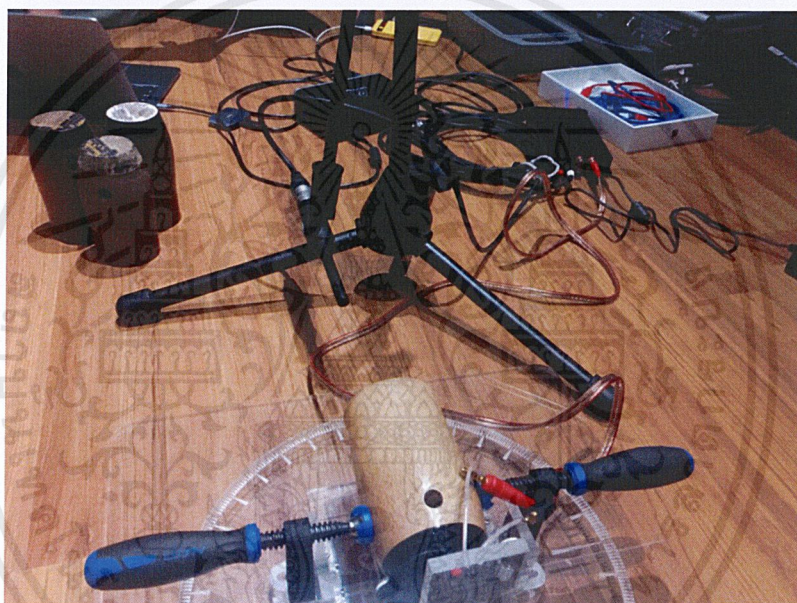
รูปที่ 3.6 การวัดระยะห่างของปากกระบอกชอถึงไมโครโฟน
