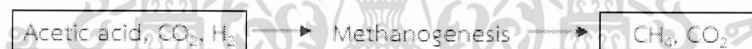
รูปที่ 2.11 การผลิตแก๊สมีเทนจากขั้นตอน Methanogenesis
