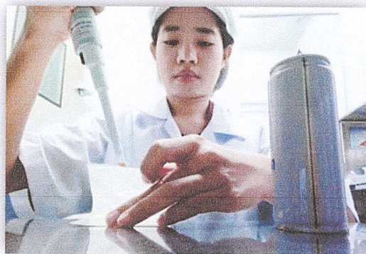
ภาพที่ 5.9 ภาพแผ่น 3M petrifilm yeast and mold count plates และภาพขณะหยดตัวอย่างลงบนแผ่น
