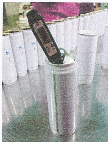
ภาพที่ 5.6 วัดอุณหภูมิของผลิตภัณฑ์จากกระป๋องแรกในการผลิต
