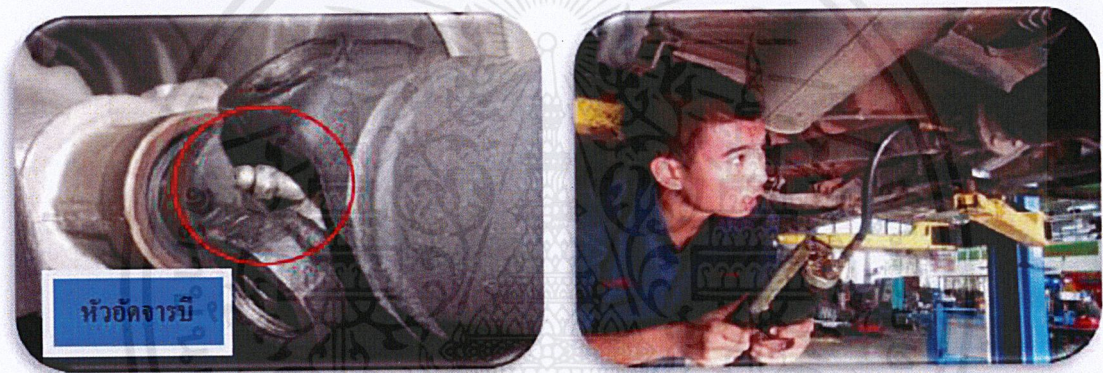
ภาพที่ 17 แสดงการหล่อลื่นข้อต่ออ่อนแบบกากบาท ด้วยจารบี
