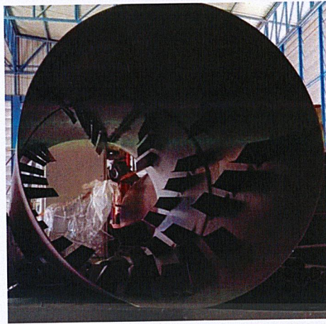
รูปที่ 3.9 ครีบกภายในถังอบแห้งแบบลูกกลิ้งหมุน
