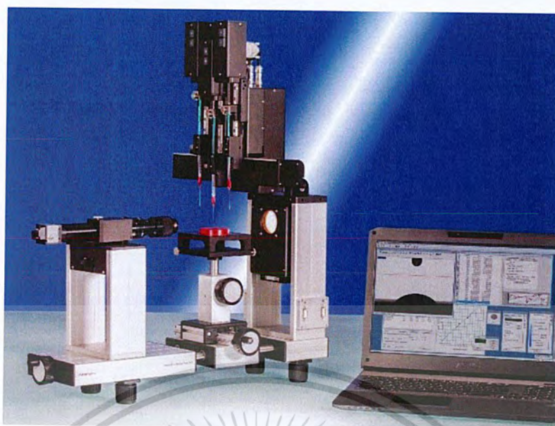
รูปที่ 3.8 เครื่องวัดมุมสัมผัสของน้ำ [22]
