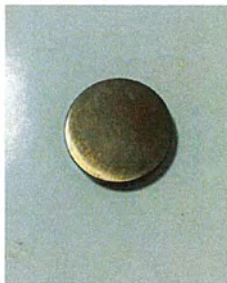
รูปที่ 4.4 ภาพชิ้นงานที่ถูกชุบด้วยนิกเกิลผสมสารละลาย \text{HAuCl}_4 มีแผ่นทองคำเปลวละลายอยู่ จำนวน 0.102 กรัมต่อลิตรของสารละลายนิกเกิลคลอไรด์ที่สภาวะ -5 \text{ mA} 8 นาที
