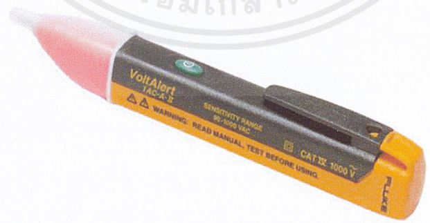
รูปที่ 2.23 ปากกาตรวจสอบไฟแบบไม่ต้องสัมผัส
