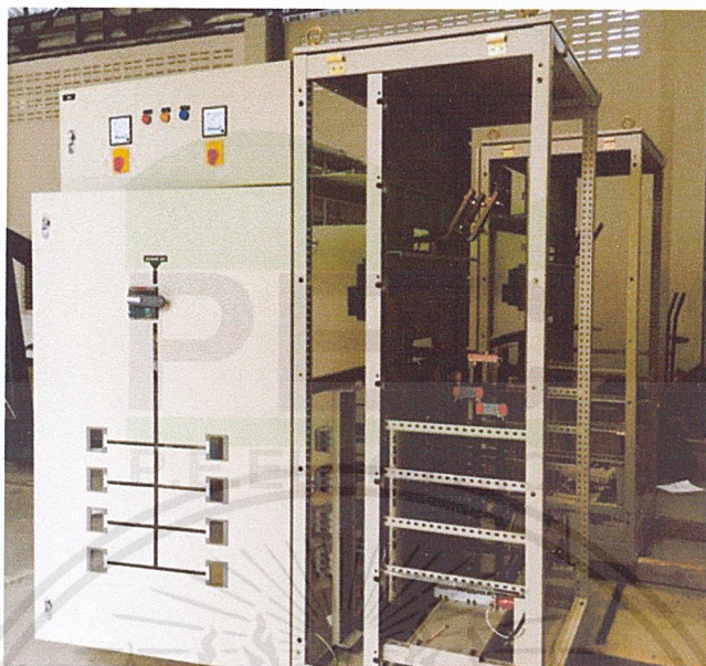
รูปที่ 2.5 โครงสร้างตู้ (Enclosure)
