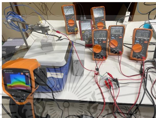
รูปที่ 3.17 การทดสอบวัด I-V curve และ P-V curve
