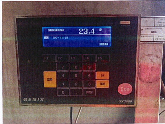
รูปภาพที่ 3.11 การวัดค่าเปอร์เซ็นต์แป้งด้วยเครื่อง Genix GX3000_ECOF
