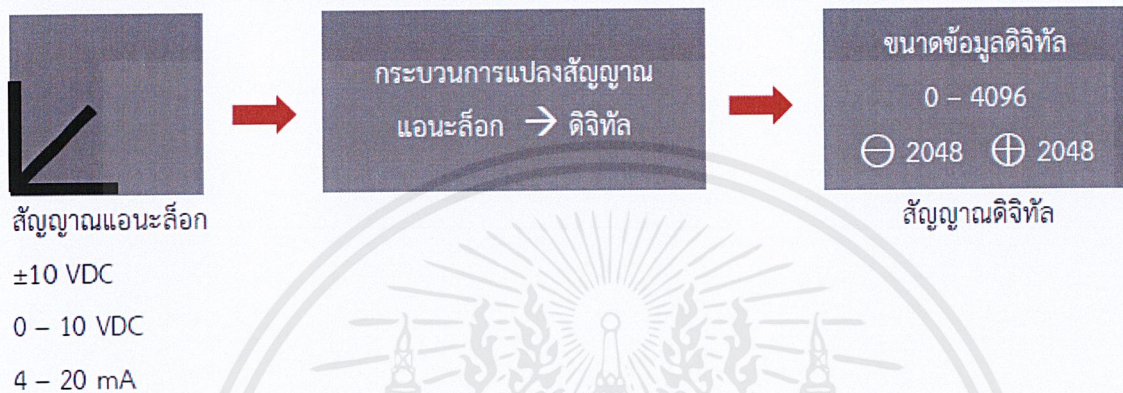
ภาพที่ 2.9 ไดอะแกรมการส่งข้อมูลแอนะล็อกให้พีแอลซี
