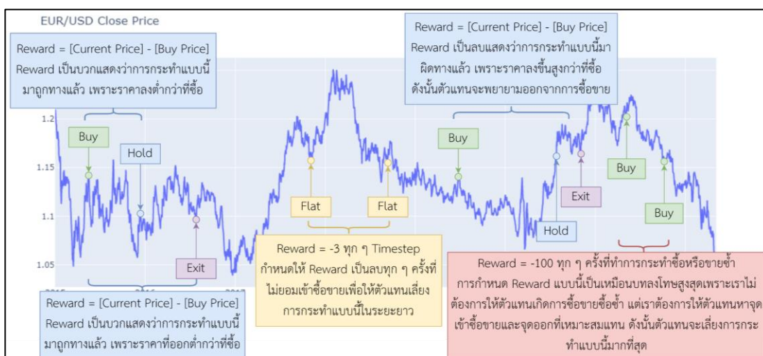
แผนภาพที่ 3.7 ตัวอย่างฟังก์ชันการให้รางวัลที่ส่งผลให้พฤติกรรมของ Agent ตรงตามความต้องการ
